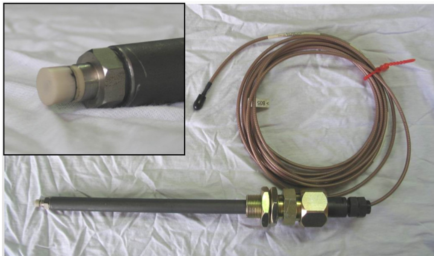
Şekil 6. Eddy-akımlı titreşim yer değişimi sensörü (sol üstte) ve sensör montaj-ayar aparatı
