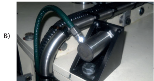
Şekil 3. Ünitelerde kurulu bulunan titreşim izleme sisteminin şematik gösterimi.
